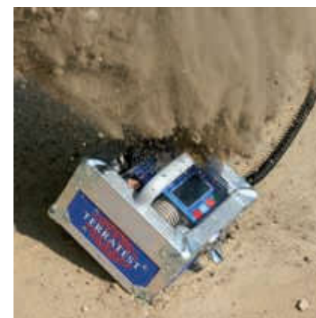
Miernik TERRATEST® podczas obsługi za pomocą zewnętrznego przycisku pozostaje zamknięty i jest chroniony na budowie.
