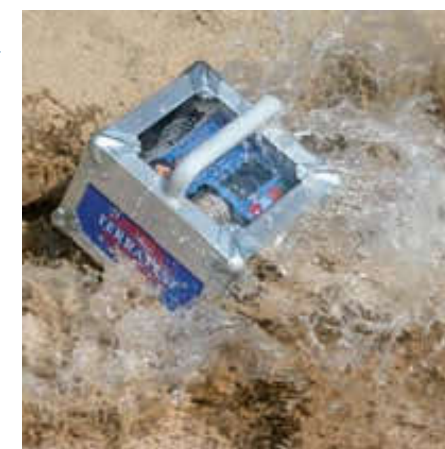
Miernik TERRATEST® posiada obecnie klasę ochrony IP53 i jest chroniony przed kurzem i wilgocią.
