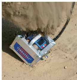
Komputer pomiarowy TERRATEST® posiada klasę ochrony IP 53 przed kurzem i penetracją wilgocią
