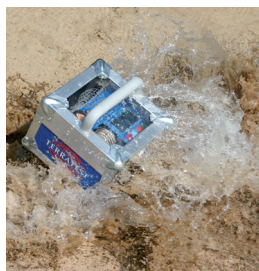
Komputer pomiarowy TERRATEST® posiada klasę ochrony IP 53 przed kurzem i penetracją wilgocią
